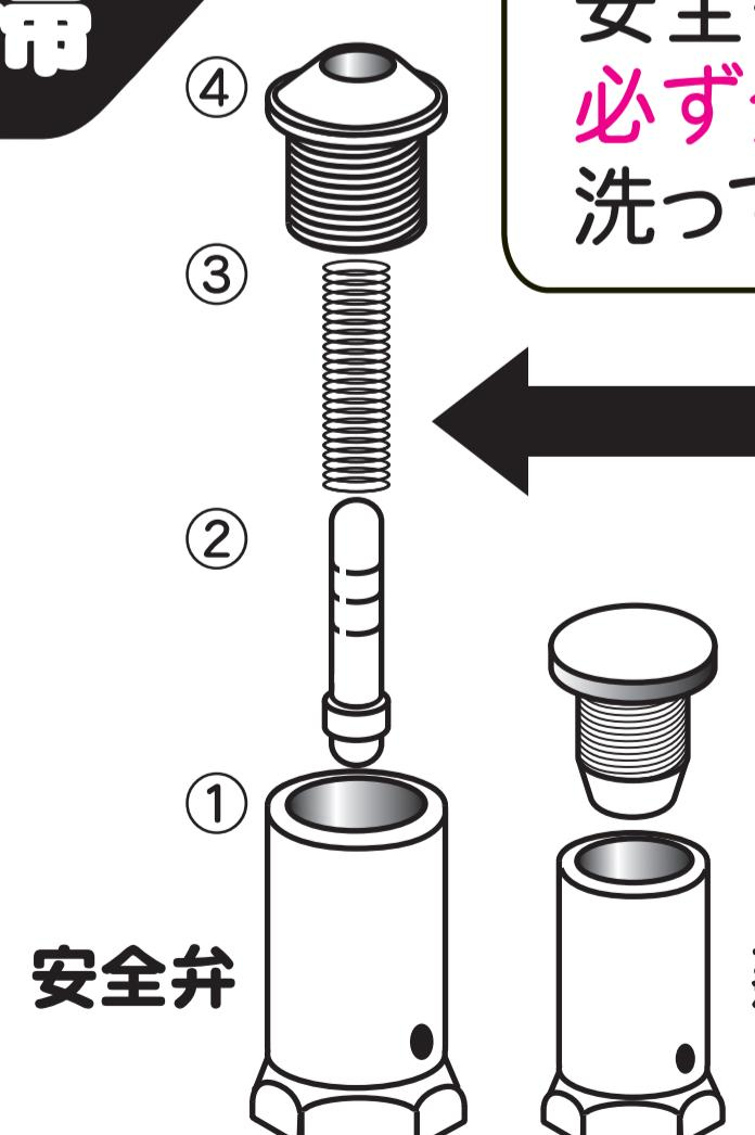
安全弁と蒸気抜は必ず分解して水で洗ってください。
